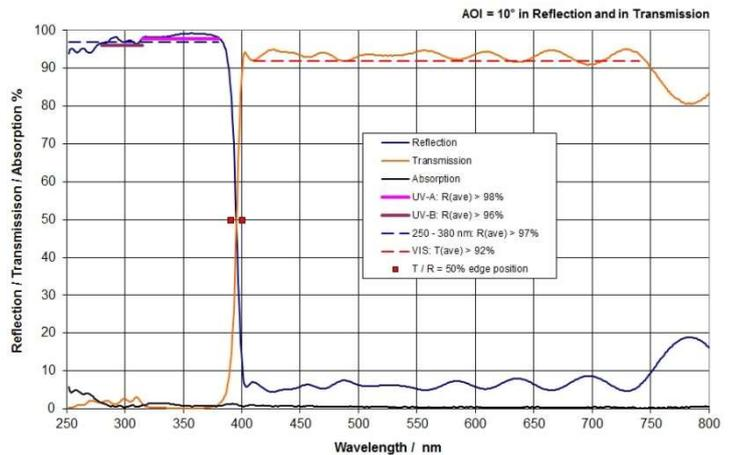
Aufgrund der hohen Reflektivität dieses Filters im UV-A und UV-B kann er auch als Kaltlichtspiegel zur Reflexion dieser beiden UV-Bereiche unter nahezu senkrechtem Einfall eingesetzt werden.
